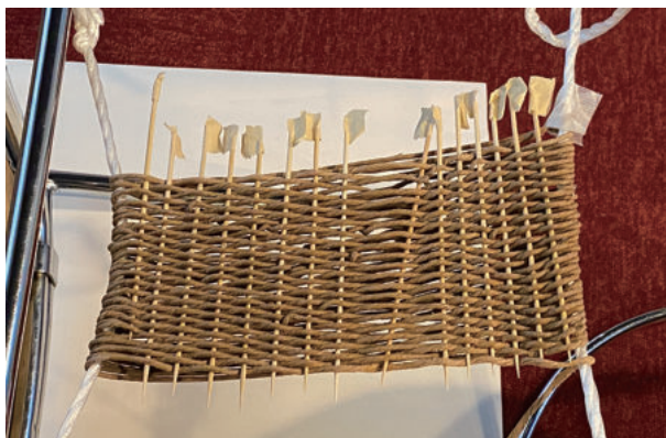
③麻紐を固定しないと刺した竹串も固定できない。
