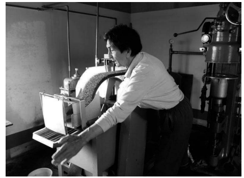
図12 罐の洗浄(再現)
